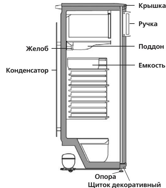
Рисунок 7 – Схема слива талой воды
